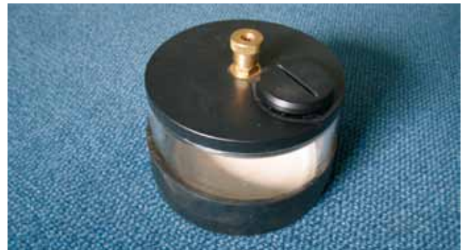
Bezugselektrode Cu/CuSO 4 für direkten Kontakt mit der Erdoberfläche Modell: CUS-01
