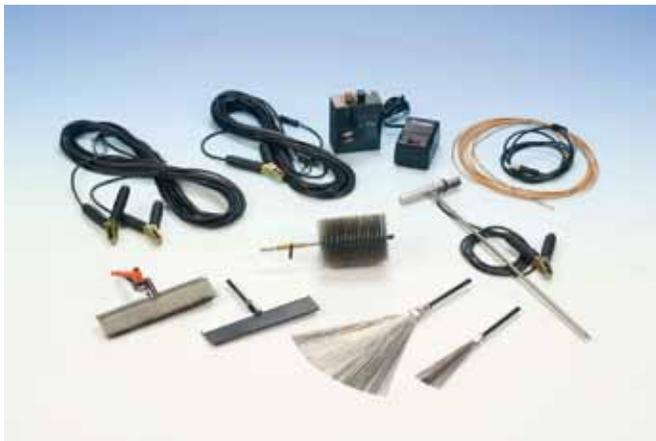
Ob Innenprüfung, Mannloch, Prüfung vollständig umhüllter Teile oder übergroße Rohrdurchmesser. Das Zubehörprogramm bietet das richtige Werkzeug.
