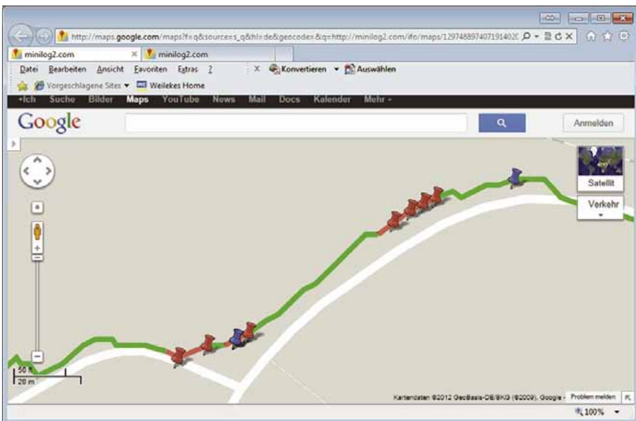
IFO Messung mit Route und Fehlstellenmarkierung in Google® Maps
