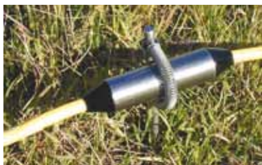
Dauerhafte, wasserdichte Kabelverbindung zum Elektrodenschalter
