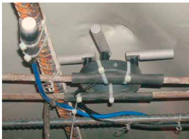
Empfohlene Installation auf Bewehrungsstäbe. CorroWatch Probe in Kombination mit einer Bezugselektrode ERE 20 (blaues Kabel).
