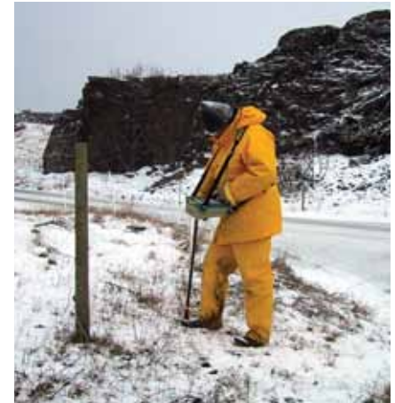
Typ - K - Zur Prüfung auf Beeinflussung zwischen geschützter und ungeschützten Rohrleitungen oder anderen Anlagenteilen und zur Messung des Rohr/Boden-Potenzials
