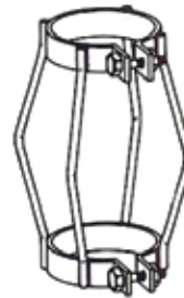
Rohrführungen zum zentrieren der Rohre im Bohrloch
