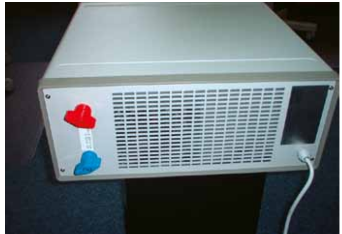
Hochstromklemmen auf der Rückseite (bis 70 A)
