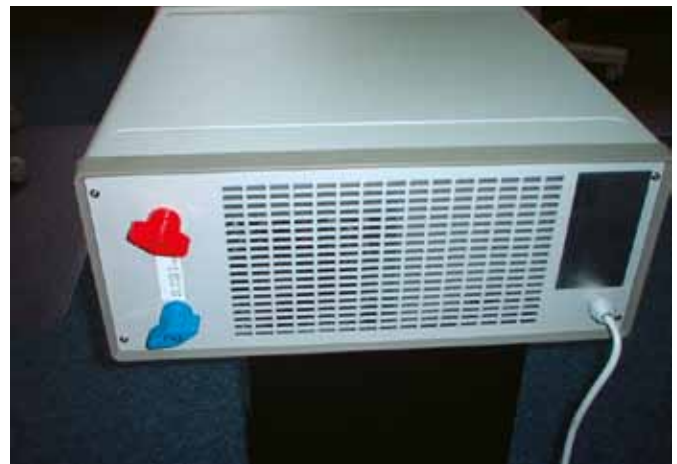
Hochstromklemmen auf der Rückseite (bis 70 A)
